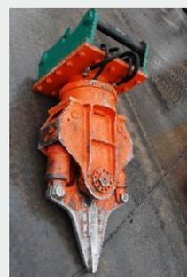
Pinsette zum entfernen vom Kabelbaum, Auspuffanlage, Lichtmaschine, usw...
