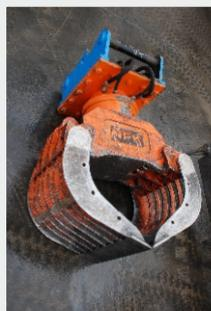
Greifer zum entfernen von Stoßstangen, Sitze, Armaturen Brett, usw...
