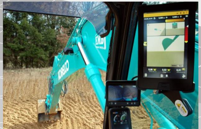
Nutzen Sie die Vorteile der neuartigen integrierten 3D-Automatik für Bagger. Durch die halbautomatische Arbeitsweise wird das Anlegen glatter, ebener oder geneigter Flächen für den Fahrer erheblich vereinfacht.
