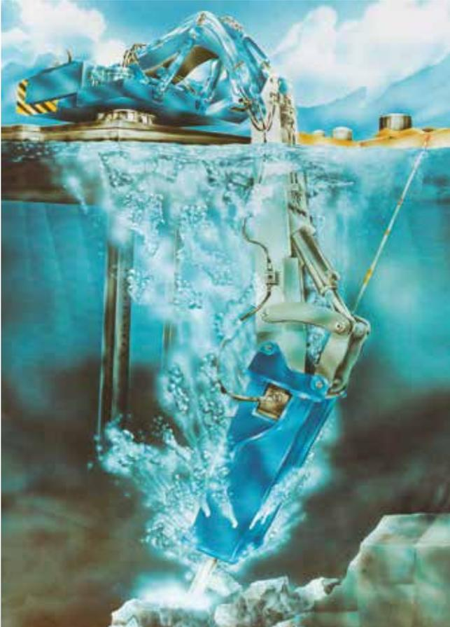
Lösung: Beaufschlagung mit Druckluft
