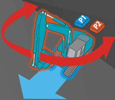
Mit „Independent Travel“ wird eine Hydraulikpumpe kontinuierlich für den Antrieb und eine kontinuierlich für das Anbaugerät eingesetzt, wodurch eine gleichmäßige und konstante Fahrgeschwindigkeit auch beim Schwenken oder beim Einsatz von Ausleger oder Anbaugeräten ermöglicht wird. Mit Independent Travel ist es ein Kinderspiel, ein großes Rohr sicher über eine Baustelle zu transportieren.
