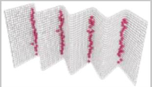
Der Edelstahl-Filter ist mit einem wellenförmig gefalteten 30er-Maschen-Filter, der winzige Staubpartikel aus der Ansaugluft entfernt, äußerst effektiv gegen Staub.
