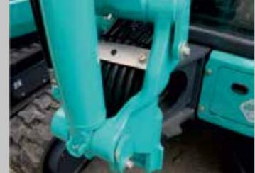
Die Hydraulikleitungen sind in der Schwenkhalterung untergebracht.
