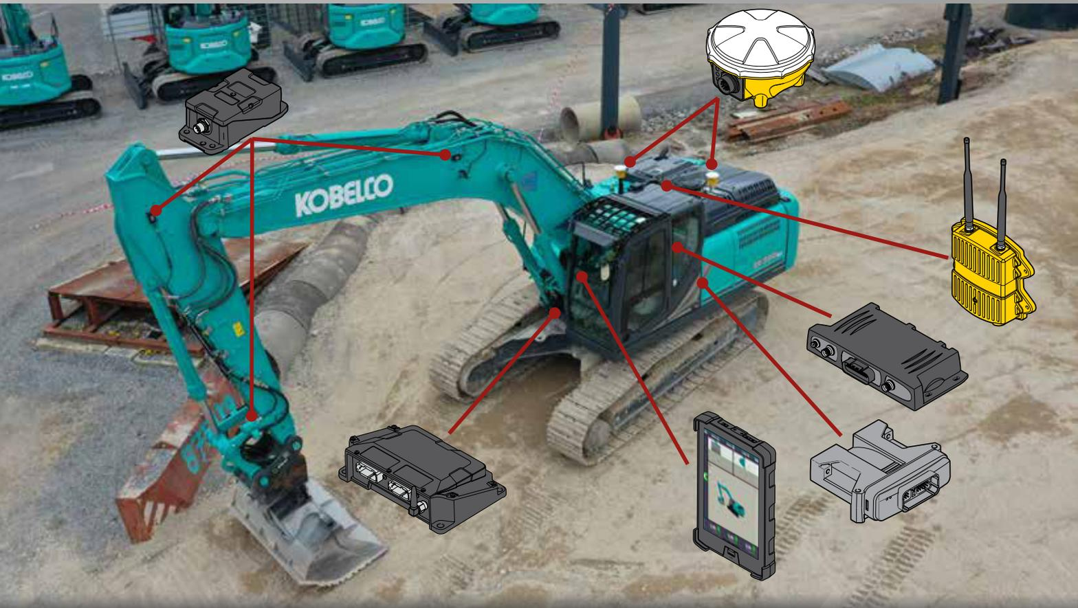
Mit einer 2D oder 3D automatischen Maschinensteuerung für KOBELCO Bagger schaffen Sie mehr in kürzerer Zeit. Diese von Grund auf neu entwickelte automatische Maschinensteuerung der neuesten Generation verfügt über eine intuitive, leicht zu erlernende Software für das Betriebssystem Android.
