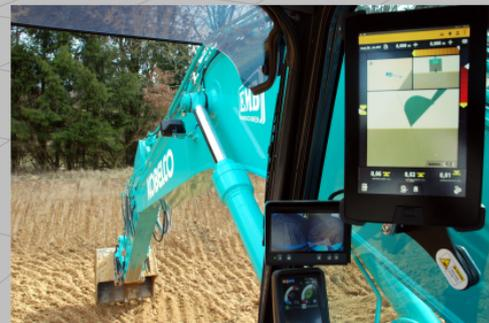
Nutzen Sie die Vorteile der neuartigen integrierten 3D-Automatik für Bagger. Durch die halbautomatische Arbeitsweise wird das Anlegen glatter, ebener oder geneigter Flächen für den Fahrer erheblich vereinfacht.
